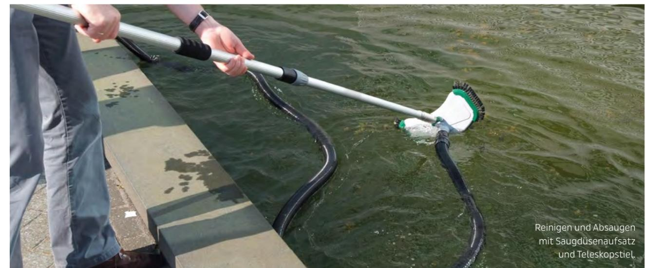
Reinigen und Absaugen mit Saugdüsenaufsatz und Teleskopstiel.
