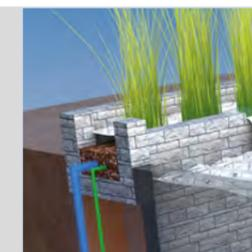
Sekundärfilter bietet zusätzlichen Phosphatpuffer
